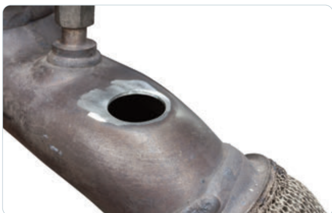
5. Bohrung entgraten. Bohrspäne sorgfältig entfernen.
