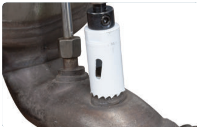
4. Temperatursensoranschluss mit einer Lochsäge (Ø 25 mm) ohne Zentrierbohrer ausschneiden. ! Es muss unbedingt darauf geachtet werden, dass keine Bohrspäne in das Filtergehäuse gelangen.
