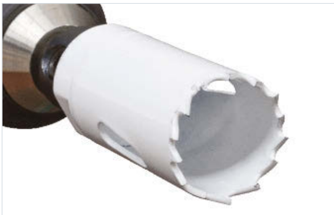
3. Ausnahmslos Ø 25 mm Lochsäge ohne Zentrierbohrer verwenden
