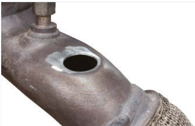
5. Bohrung entgraten. Bohrspäne sorgfältig entfernen.
