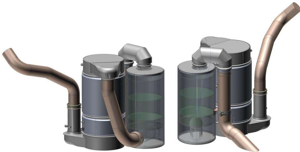
Abbildung 28: System II – SCR mit Heizkatalysator auf Basis Cu-Zeolith
