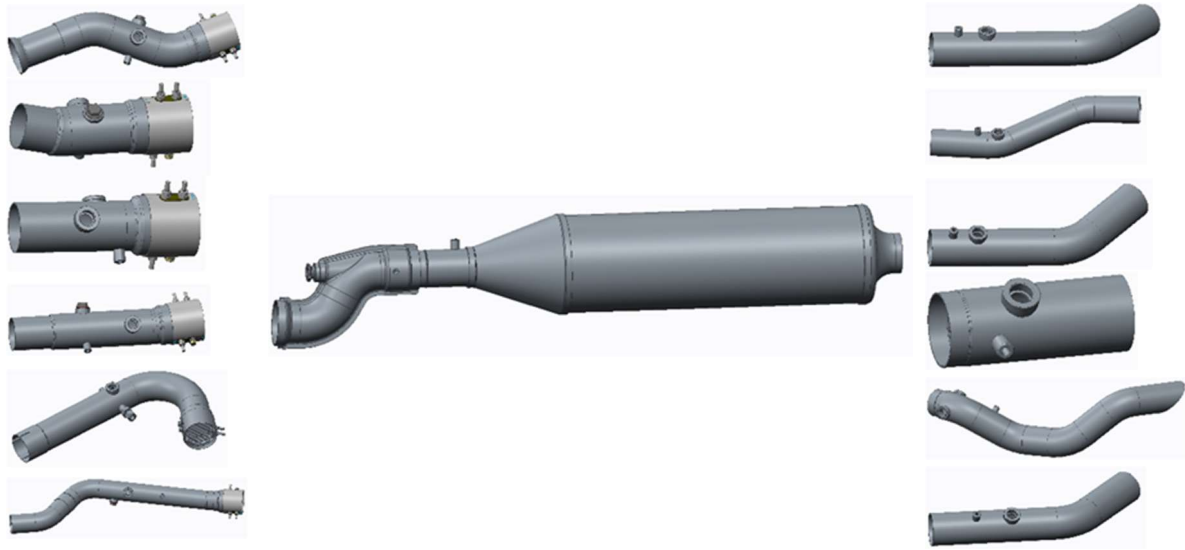
Abbildung 4: Darstellung des Baukastensystems mit Eingangs- und Ausgangsverrohrungen in der Reihenfolge MB Sprinter, VW T5, Renault Master, MB Vito, Fiat Ducato, Ford Transit (von oben nach unten)
