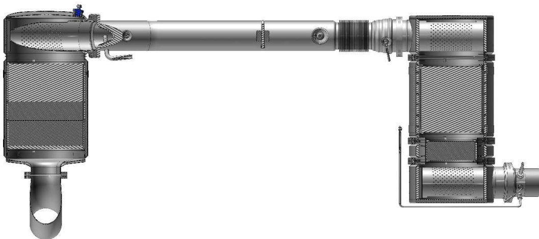
Abbildung 14: IVECO Stralis - AGN-System mit neuem SCRT und Verwendung neuer HJS-Dosierkomponenten.
