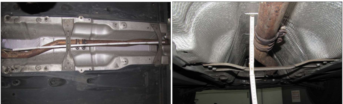
Abbildung 28: Skoda Yeti 2.0 TDI Euro 5 Baujahr 2011 – Auszug aus den Bauraumbetrachtungen.
