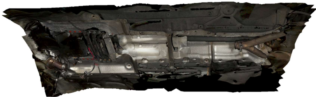
Abbildung 61: MB E300 CDI – Scan des Unterbodens mit Original-Abgasnachbehandlungssystem (Bauraum für das Nachrüstsystem).
