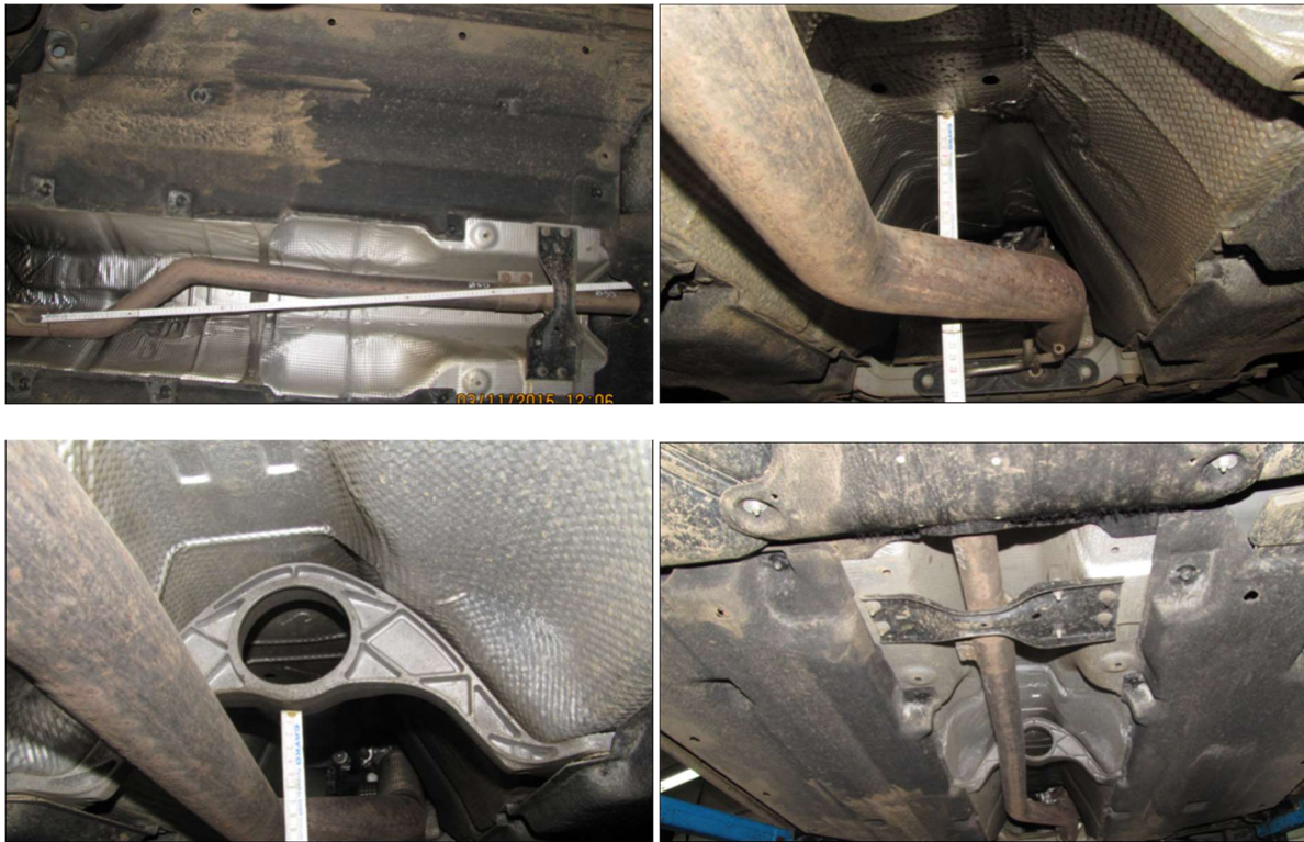
Abbildung 32: Audi Q3 2.0 Diesel Euro 5 Baujahr 2012 – Auszug aus den Bauraumbetrachtungen.
