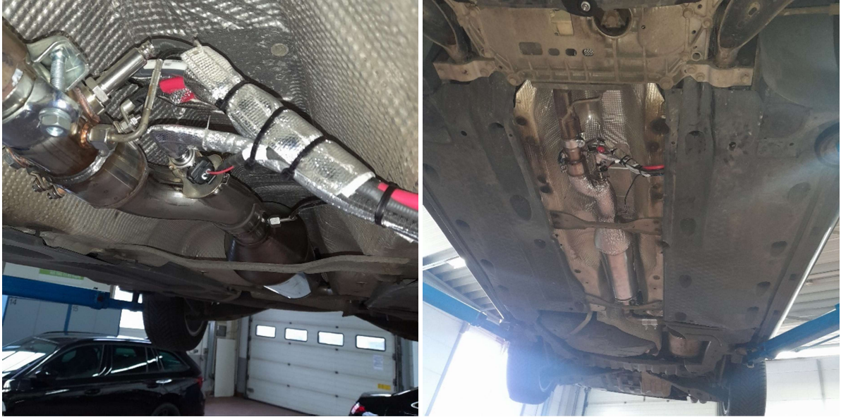
Abbildung 41: VW Passat – Scan des eingebauten SCR-Systems.
