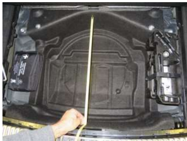
Abbildung 37: Bauraum-Betrachtung Porsche Cayenne – Unterboden und Reserveradmulde.
