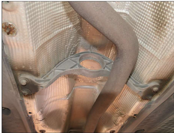
Abbildung 29: VW Tiguan Baujahr 2013 – Auszug aus den Bauraumbetrachtungen.
