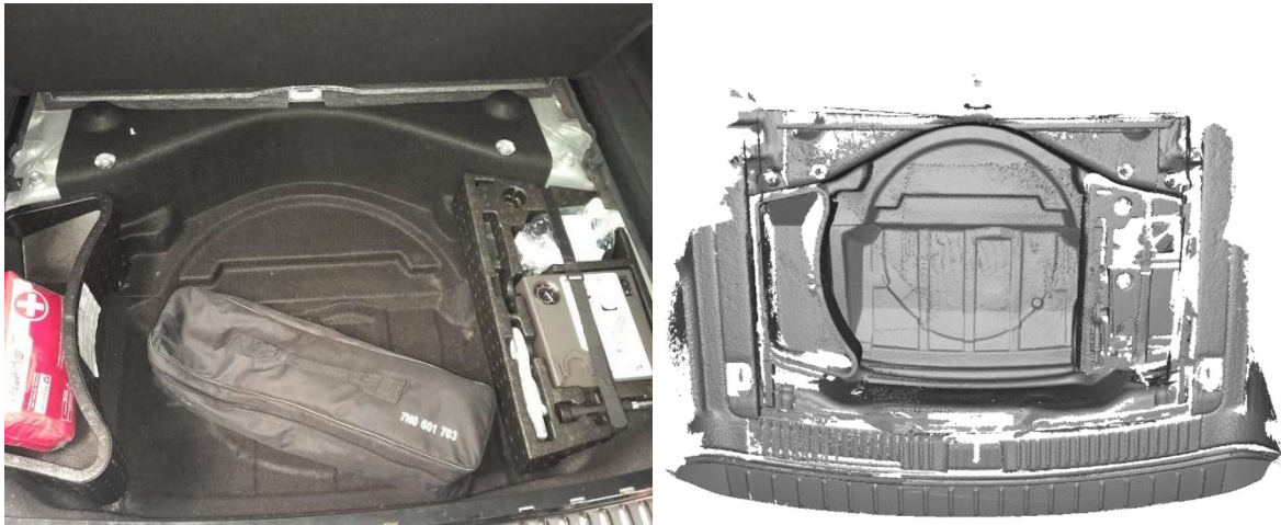
Abbildung 20: VW Touareg – Reserveradmulde als Bauraum für den AdBlue-Tank und die HJS-ACU.
