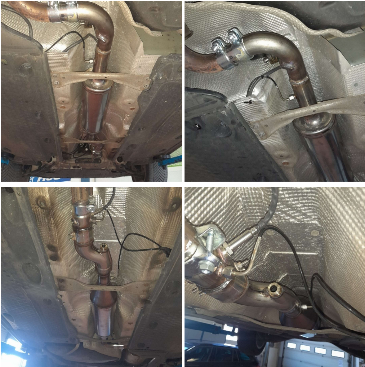
Abbildung 40: VW Passat – Einbau des Systems: SCR-System (oben), Temperatur-Sensoren (Mitte) und NO x -Sensoren vor und nach dem SCR (unten).
