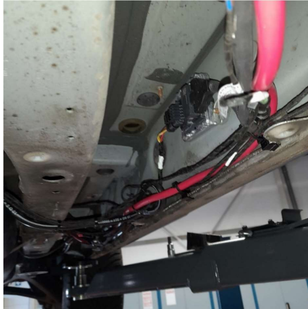
Abbildung 49: VW Touareg – NO x -Sensoren.
