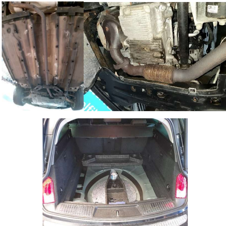
Abbildung 10: Opel Insignia – Unterboden mit Original-Abgasnachbehandlungssystem und Reserveradmulde (Bauraum für das Nachrüstsystem).
