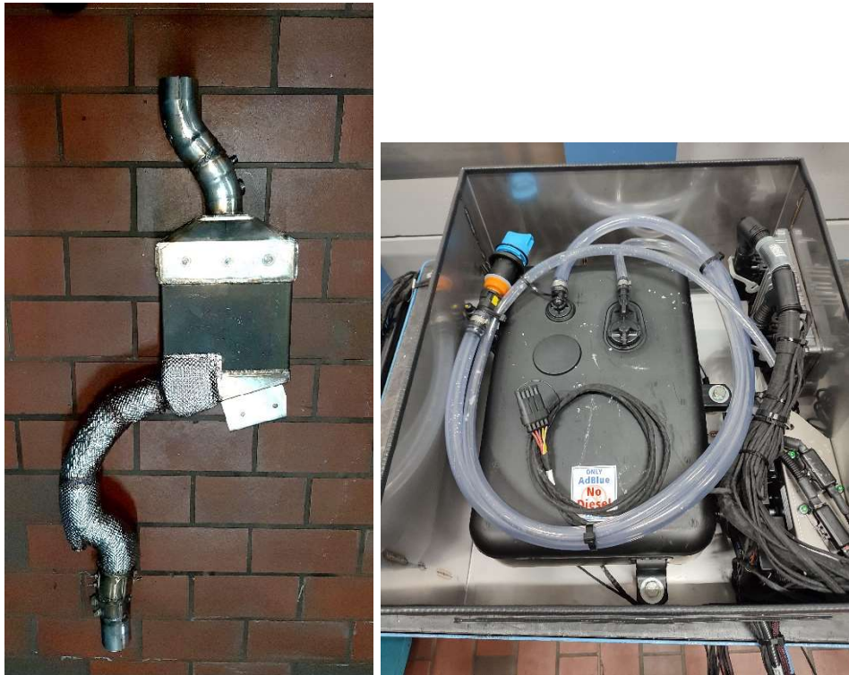
Abbildung 17: Muster des SCR-Systems mit Dosierung, Heizung und Anschlussverrohrung (am Beispiel des X3 mit 6-Zylindermotor)
