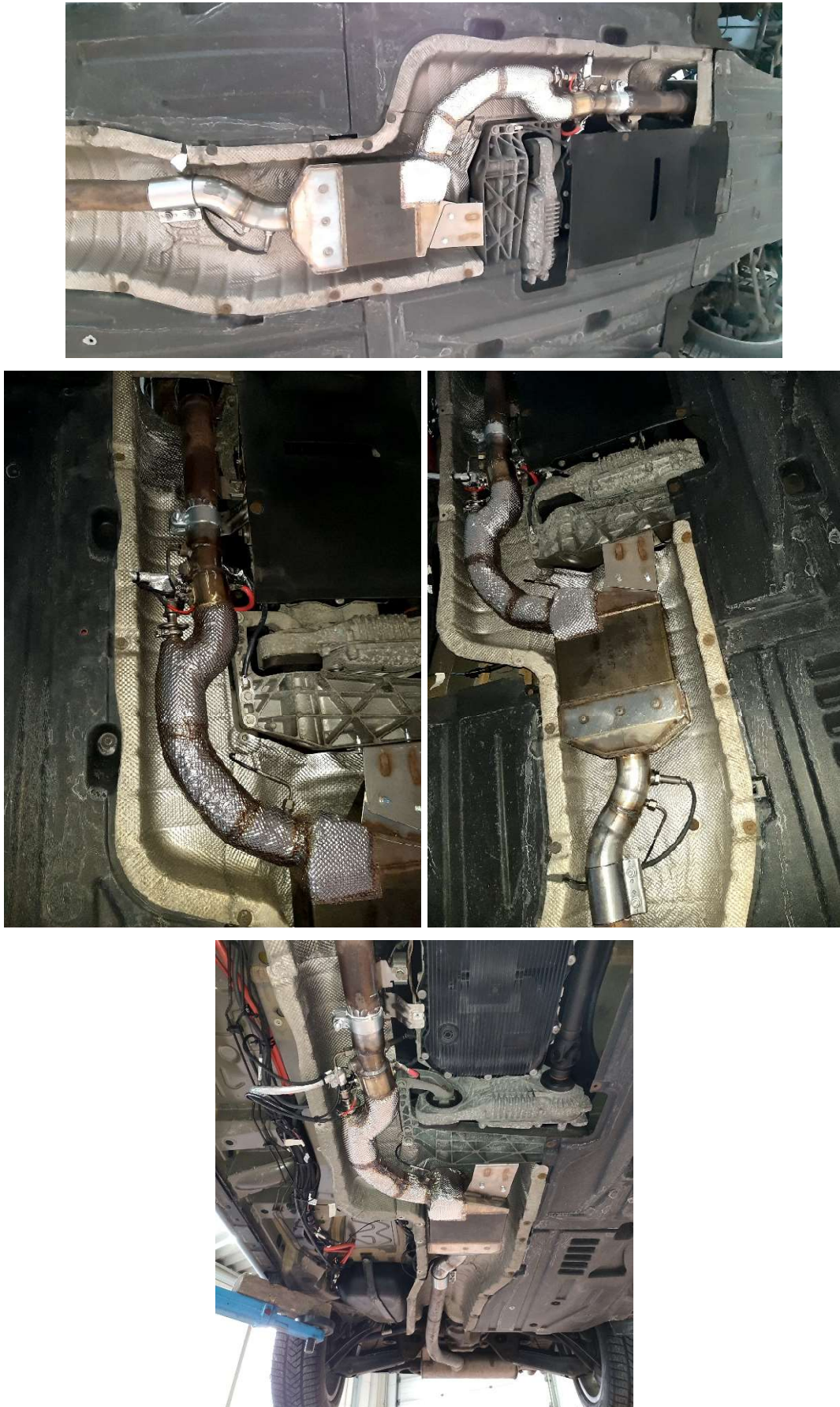
Abbildung 23: X3 (6-Zylinder) mit SCR-Nachrüstsystem
