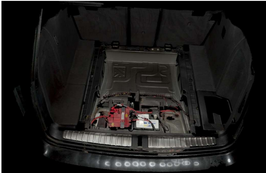
Abbildung 5: Scan des Unterbodens nach Ausbau der Original-Abgasführung (Bauraum für das SCR-Nachrüstsystem) und der Mulde im Kofferraum (am Beispiel des X3 4-Zylinder).
