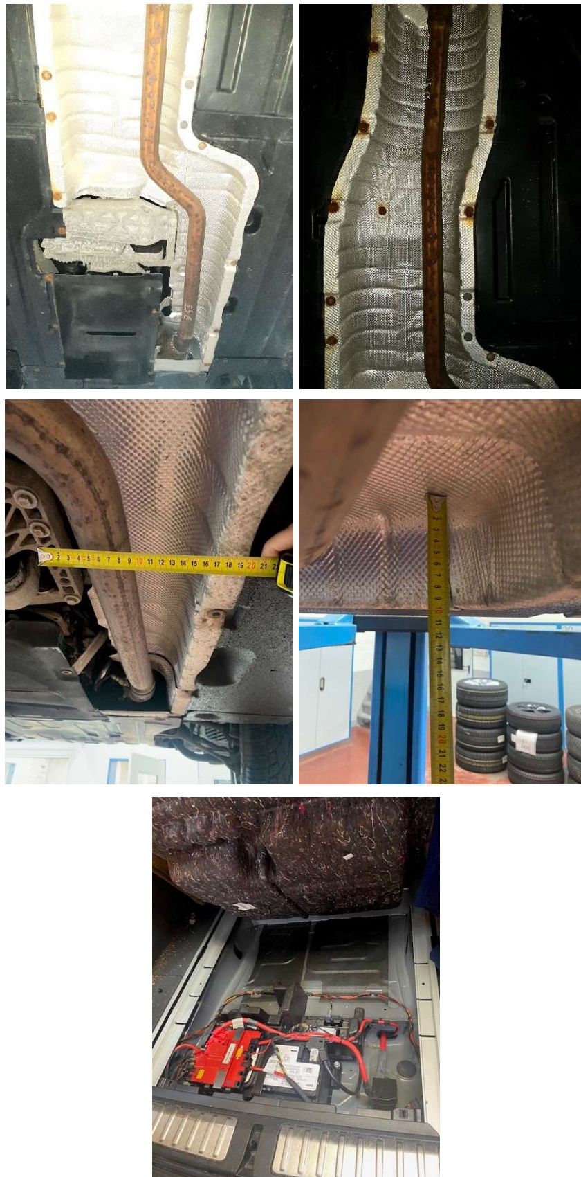
Abbildung 4: Unterboden der Prüffahrzeuge mit Original-Abgasnachbehandlungssystem (Bauraum für das Nachrüstsystem) und Kofferraummulde (am Beispiel des Prüffahrzeuges BMW X3 mit 4-Zylindermotor)
